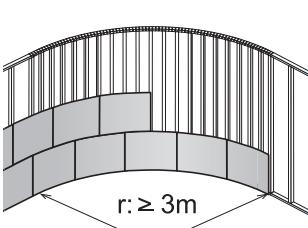
Перед закреплением плит рекомендуется предварительно согнуть плиту по необходимому радиусу. Возникающие при этом волосяные трещины не приводят к потере прочности и эксплуатационных свойств плит.
